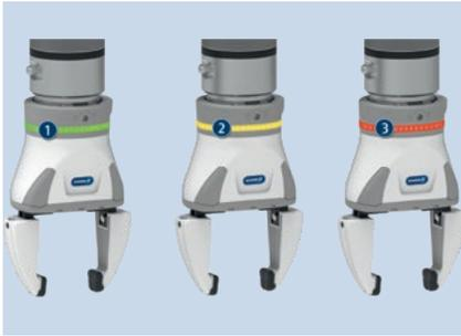
La pince SCHUNK Co-act EGH est équipée d'une bande lumineuse LED intégrée qui peut indiquer l'état de fonctionnement de la pince. La bande lumineuse peut être éclairée en trois couleurs différentes. Elles peuvent être définies en fonction de l'application et contrôlées individuellement par des entrées digitales.
